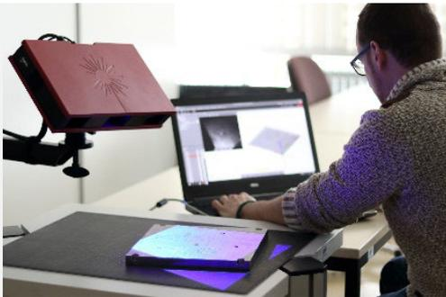
Additiv gefertigte Werkstücke benötigen oft noch eine spanende Nachbearbeitung. Dazu wird im nächsten Schritt ein 3D-Scan erstellt und ein Soll-Ist-Vergleich durchgeführt. Dieser ermöglicht zum Schluss eine genauere, zeitoptimierte CNC-Bearbeitung.
