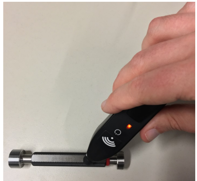
Abb. 2: Auslesen der Informationen eines RFID-Tags
