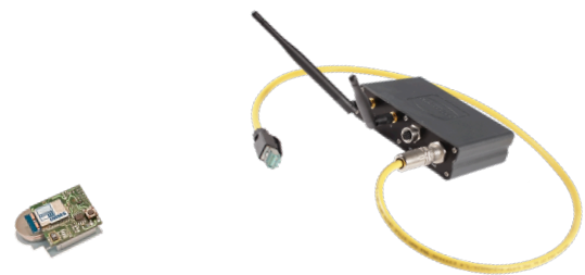
Abb. 2: Funksensorknoten und Gateway zur Übertragung der Daten des Sensornetzwerkes z.B. in die Cloud
